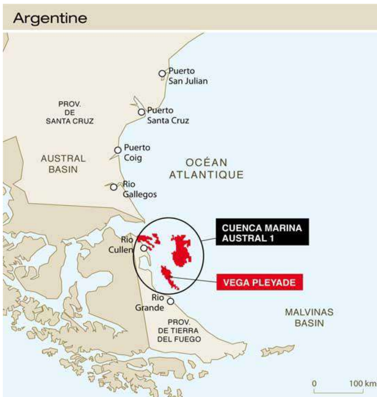
Fig. 19 : Vega Pleyade est situé au large de la Terre de Feu, sur le permis de Cuenca Marina Austral 1 (CMA-1) qui est opéré par Total depuis 1978. Le champ sera développé au moyen d'une plateforme tête de puits implantée dans 50 m d'eau et raccordée par un pipeline de 77 km aux installations de traitement à terre de Rio Cullen et Cañadon Alfa, également opérées par Total. Source : Energine , 2013.
